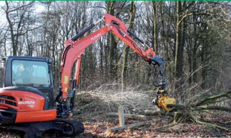
Der Fällgreifer lässt sich ohne technische Anpassungen an jeden Kran mit normalen Holzgreifer montieren.
